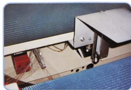
Folienschneidevorrichtung mit thermischer Ansigelung des Restfolienendes
