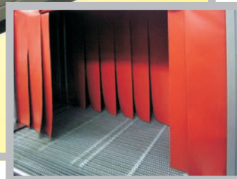
Vor- und Nachkammer mit doppelten Spezial-Silikonglasgewebehängen
