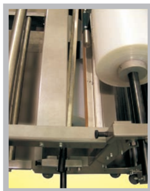
Folienanschweißvorrichtung für seitlich angeordnetes Folienlager Film welding system for laterally positioned film stock Équipement de souder de film des magasins disposés latéralement
